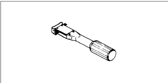
Valve Seat Cutter,  $32^\circ - \phi 33.0$  : 57001-1199
